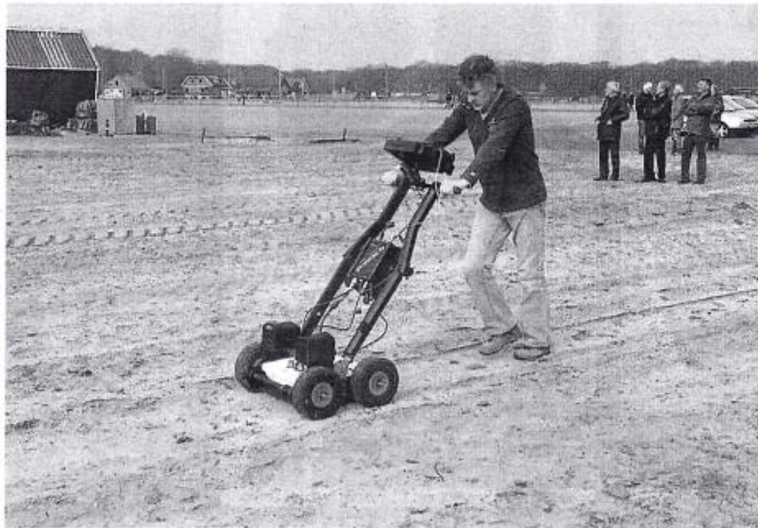
Ron van Wezop trekt een baantje met zijn grondradar.
